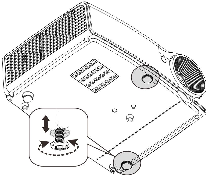
Для изменения угла проецирования изображения поверните регулятор наклона вправо или влево до установки нужного угла.
